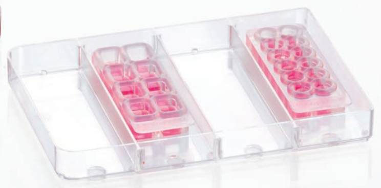
quadriPERM® flexiPERM® slide와 flexiPERM® micro 12 의 조합
