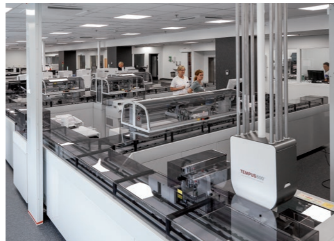
Tempus600® 连接模块作为样品自动化一键式处理系统的一部分，可带来诸多好处，比如减少了工作流程，不需手动处理样品管，处理更迅速、可靠。
