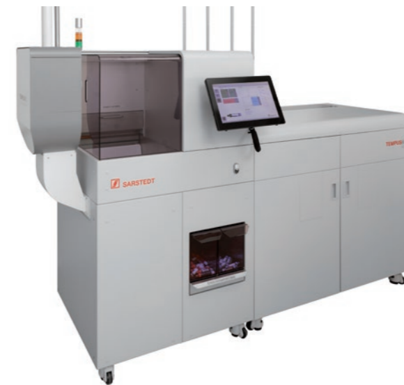
Tempus600® Necto 可以连接到输送带，也可以手动装载样本。该系统简化了整个登记和分选过程，可以将样本运输到最多六个不同目的地。
