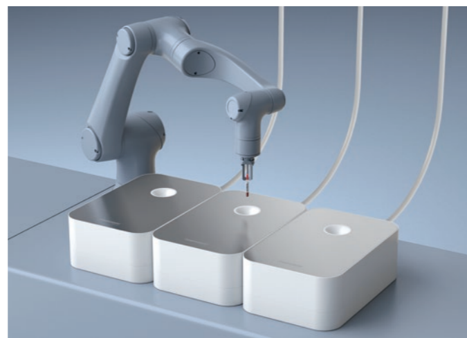
Tempus600® Solus 用于样本解包后的重新分配。如果有一个以上的目的地，只需增加相同数量的发送站即可。
