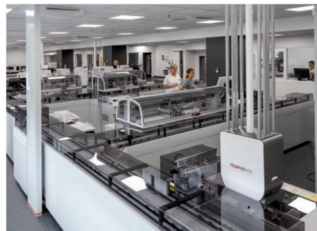
El módulo de conexión Tempus600®, como parte de un sistema automatizado de manipulación 'one-touch' para tubos de muestras, proporciona una amplia gama de beneficios, como menos procedimientos de trabajo, manipulación de tubos de muestra y, en general, una manipulación más rápida y segura.
