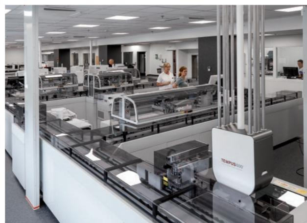
Le module de connexion Tempus600®, comme partie intégrante d'un système automatisé de manipulation en un seul geste des tubes échantillon, offre une panoplie d'avantages tels que la diminution des procédures de travail, l'absence de contact avec les tubes échantillon et, globalement, une manipulation plus rapide et plus sûre.
