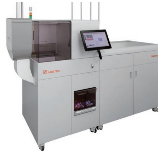
Tempus600® Necto peut être connecté à un tapis roulant ou les échantillons peuvent être chargés manuellement. Le système rationalise tout le processus d'enregistrement et de tri, ce qui permet de transférer les échantillons vers six destinations différentes maximum.
