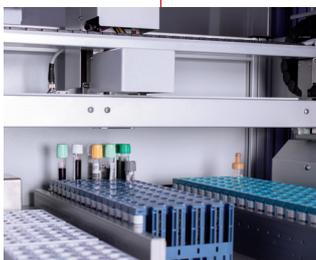
Au niveau du Sorter 2, les tubes sont insérés dans des plots de centrifugation. Les racks partiellement chargés sont automatiquement complétés par des tubes de compensation pour la centrifugation.
