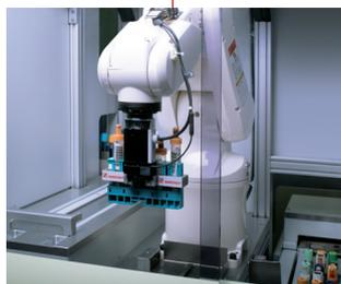
Le bras robotique du module SORT CONNECT transfère les racks système du trieur Bulk Sorter vers le système de laboratoire.
