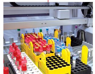
Les échantillons qui ne sont pas destinés au système de laboratoire sont triés ici, placés dans des racks et préparés pour un retrait manuel.
