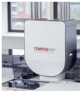
Vzorky jsou přijaty pomocí připojovacího modulu nebo přijímací stanice systému Tempus600® v laboratoři.
