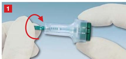
1. Rodar a tampa de proteção para abrir (1/4 giro)
