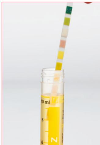
Стандартные тест-полоски для химического анализа мочи можно удобно погружать в заполненную пробирку Urin-Monovette®.
