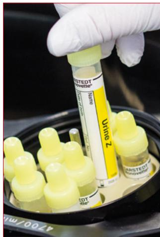
Использование Urin-Monovette® в качестве центрифужной пробирки сокращает время анализа. После декантирования надосадка можно гигиенично извлечь осадок.
