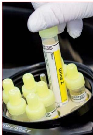
L'utilisation directe comme tube à centrifuger réduit la durée d'analyse. Suite à la décantation du surnageant, le piston peut être remonté et le sédiment peut alors être prélevé de manière hygiénique.
