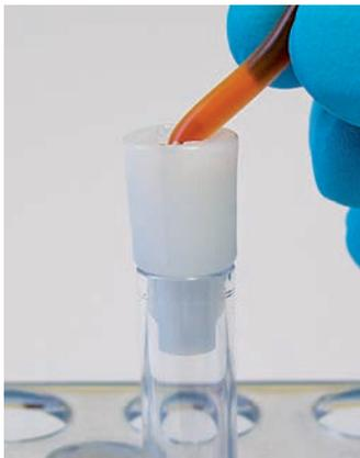
Führen Sie das Schlauchsegment leicht angewinkelt in den Schlauch-Segment-Öffner ein und schieben Sie dieses nach vorn, ohne den Schlauch zu quetschen.
