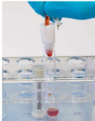
Zur Entleerung des Schlauchsegmentes falten und quetschen Sie den Schlauch. Tropfen vermeidet man durch nachlassenden Druck vor der Entfernung des Segmentes aus dem Schlauch-Segment-Öffner.
