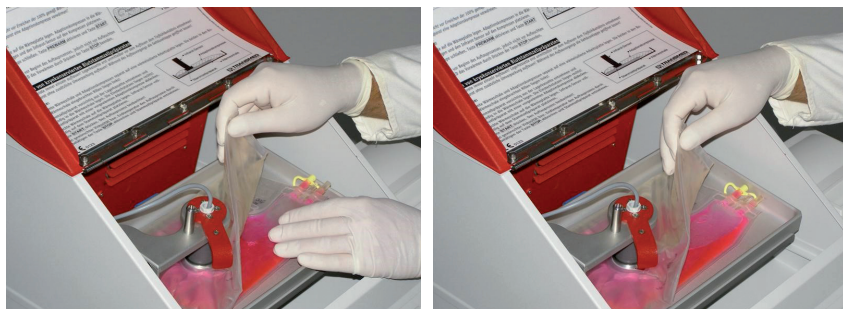
Ryc. 5 i 6: Dotykowa i wzrokowa kontrola lepkości preparatu
